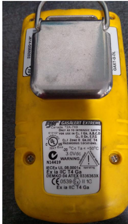
BW GasAlert Extreme O<sub>3</sub> Gas Detector (Yellow) – Campo di misura: 0 – 1 PPM di OZONO
