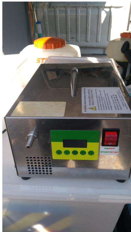
Si riporta di seguito foto e riferimenti dell'analizzatore di concentrazione di O<sub>3</sub> usato:
